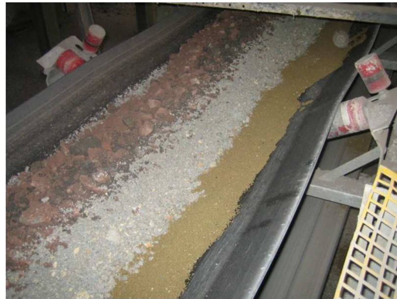
Gemeinsamer Transport der Rohstoffkomponenten (rechts Mineralwolleabfälle) zur Aufbereitung
