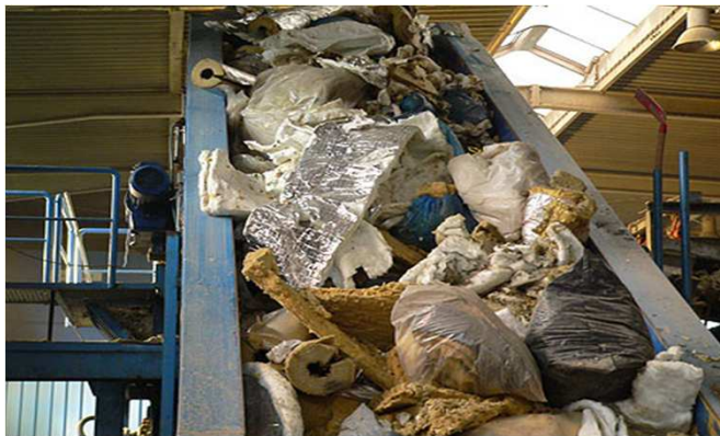
Mineralwolleabfälle im Anlieferungszustand
