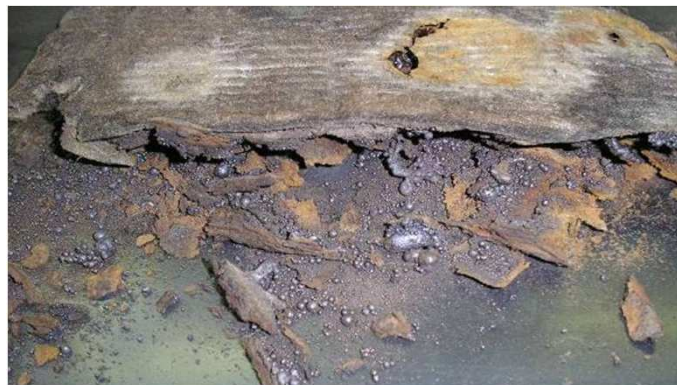
Im Inneren aufgeschmolzene Mineralfaserprobe
